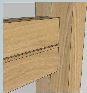
Usinage grain d'orge sur montant, cintres (imposte) et traverses intermédiaires élargies ( V.fixes + vantaux )
