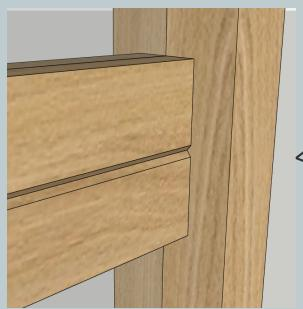
Usinage grain d'orge sur montant , cintres (imposte) et traverses intermédiaires élargies ( V.fixes + vantaux )
